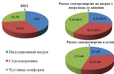
Рис. 7. Графический анализ различных видов нагревательных элементов электроплит
